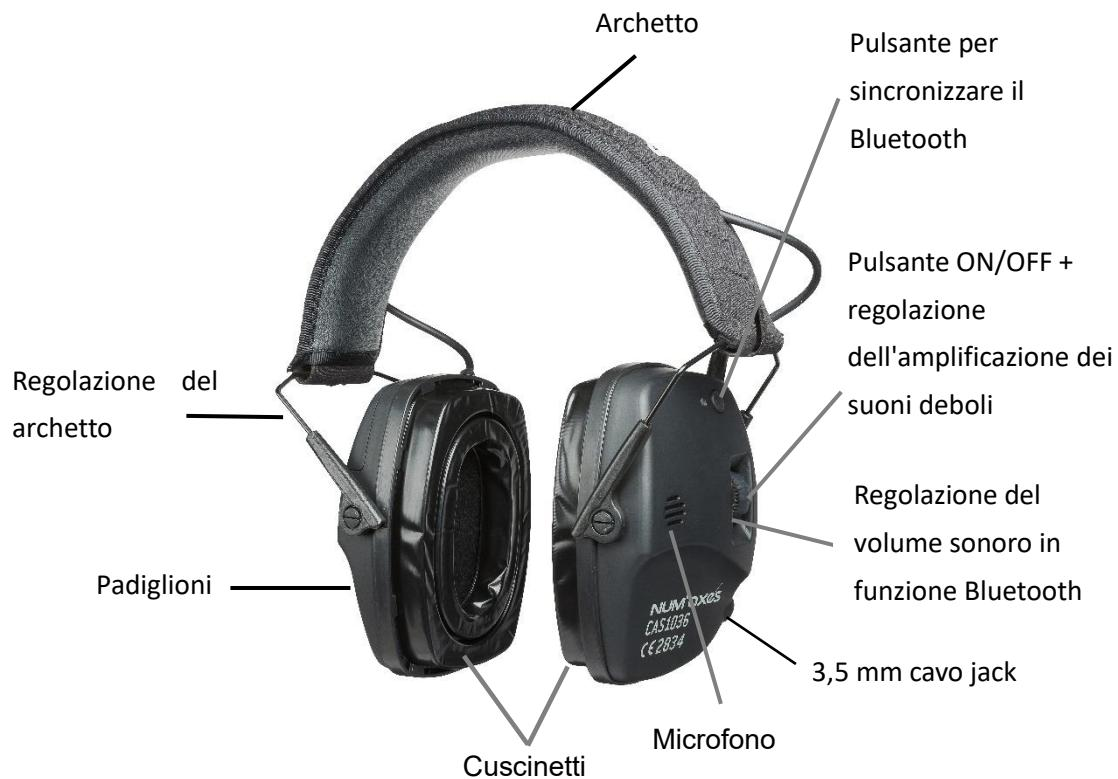
L'archetto e i cuscinetti, le parti delle cuffie a contatto con l'utilizzatore, sono in ABS, PU e silicone. Inoltre la forza dell'archetto non è regolabile ma i cuscinetti in silicone sono sostituibili.
