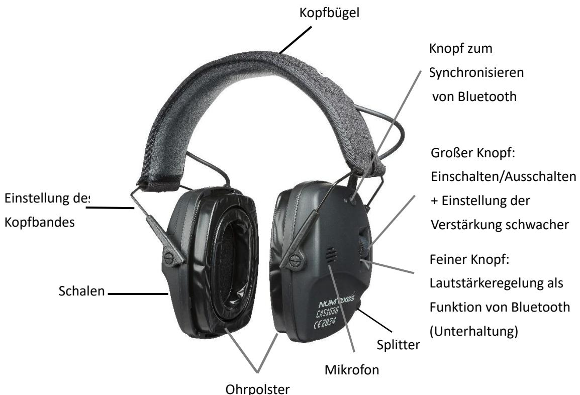
Der Kopfbügel und die Ohrpolster, die beide direkten Hautkontakt haben, bestehen aus ABS, PU und Silikon. Die Kraft des Kopfbandes ist nicht einstellbar. Die Silikon-Ohrpolster sind austauschbar. Unter normalen Lager-, Gebrauchs-, Reinigungs-, Pflege- und Wartungsbedingungen beträgt das Verfallsdatum Ihres Gehörschutzes 5 Jahre (ab Kaufdatum). Denken Sie daran, Ihren Gehörschutz jährlich von einem Fachmann warten zu lassen.
