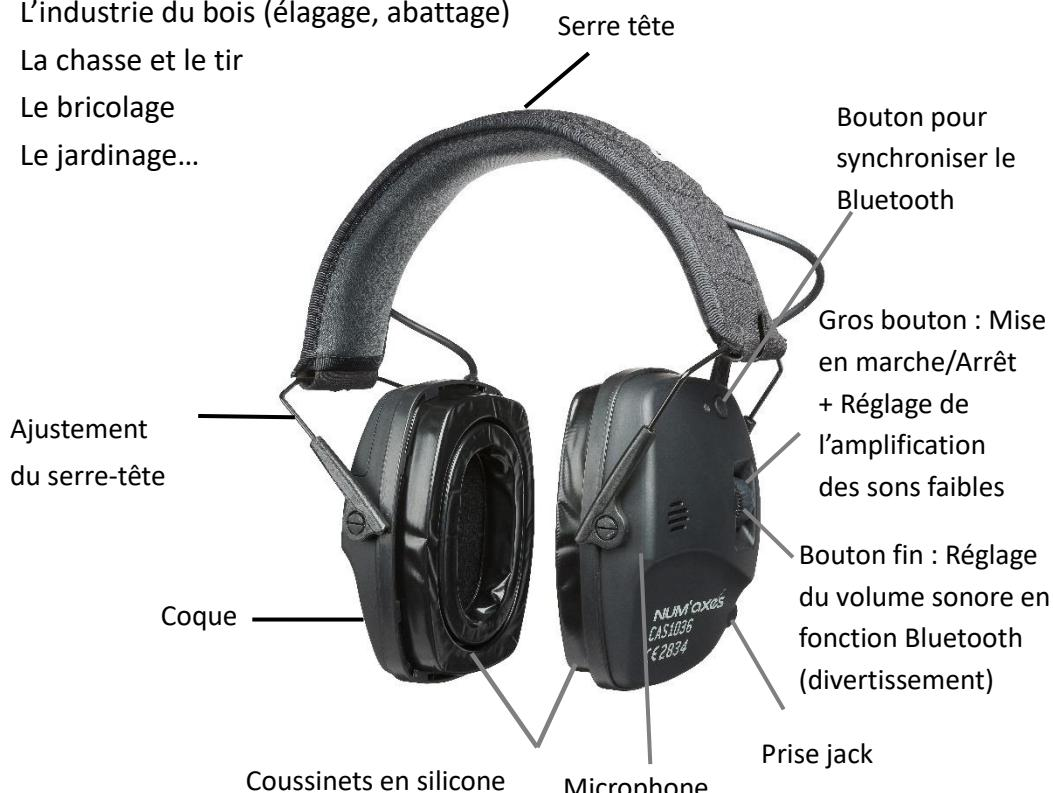
Le serre-tête et les coussinets sont les parties du casque qui sont en contact avec l'utilisateur. Ils sont composés d'ABS, de PU et de silicone. La force du serre-tête n'est pas ajustable. Les coussinets en silicone sont quant à eux remplaçables.
