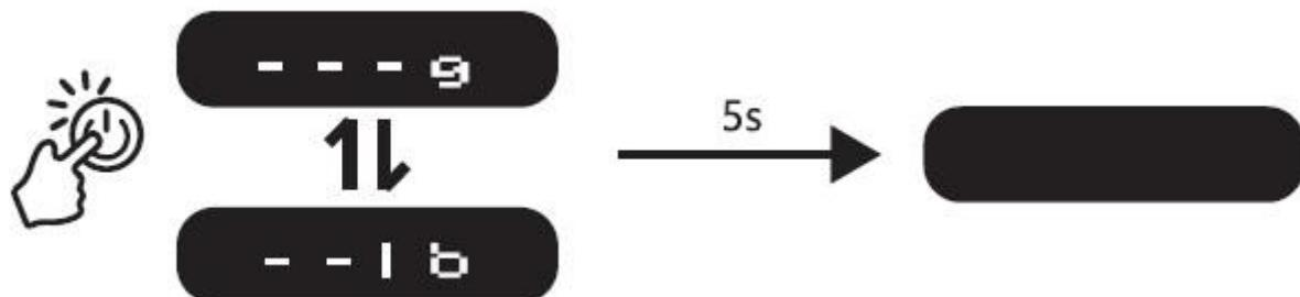
La pantalla se apagará automáticamente tras 5 segundos de inactividad.
