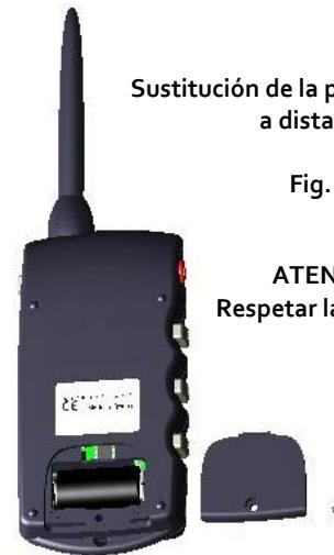
Sustitución de la pila en el mando a distancia
