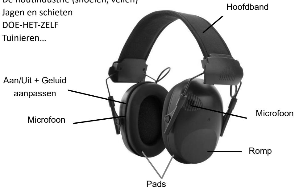
De hoofdband en kussentjes zijn de onderdelen van de helm die in contact komen met de drager. Ze zijn gemaakt van ABS en PU. De sterkte van de hoofdband is niet verstelbaar en de oorkussens zijn niet vervangbaar. Onder normale omstandigheden van opslag, gebruik, reiniging, verzorging en onderhoud is de houdbaarheidsdatum van je helm 5 jaar (vanaf de aankoopdatum). Vergeet niet om je helm jaarlijks te laten onderhouden door een professional.
